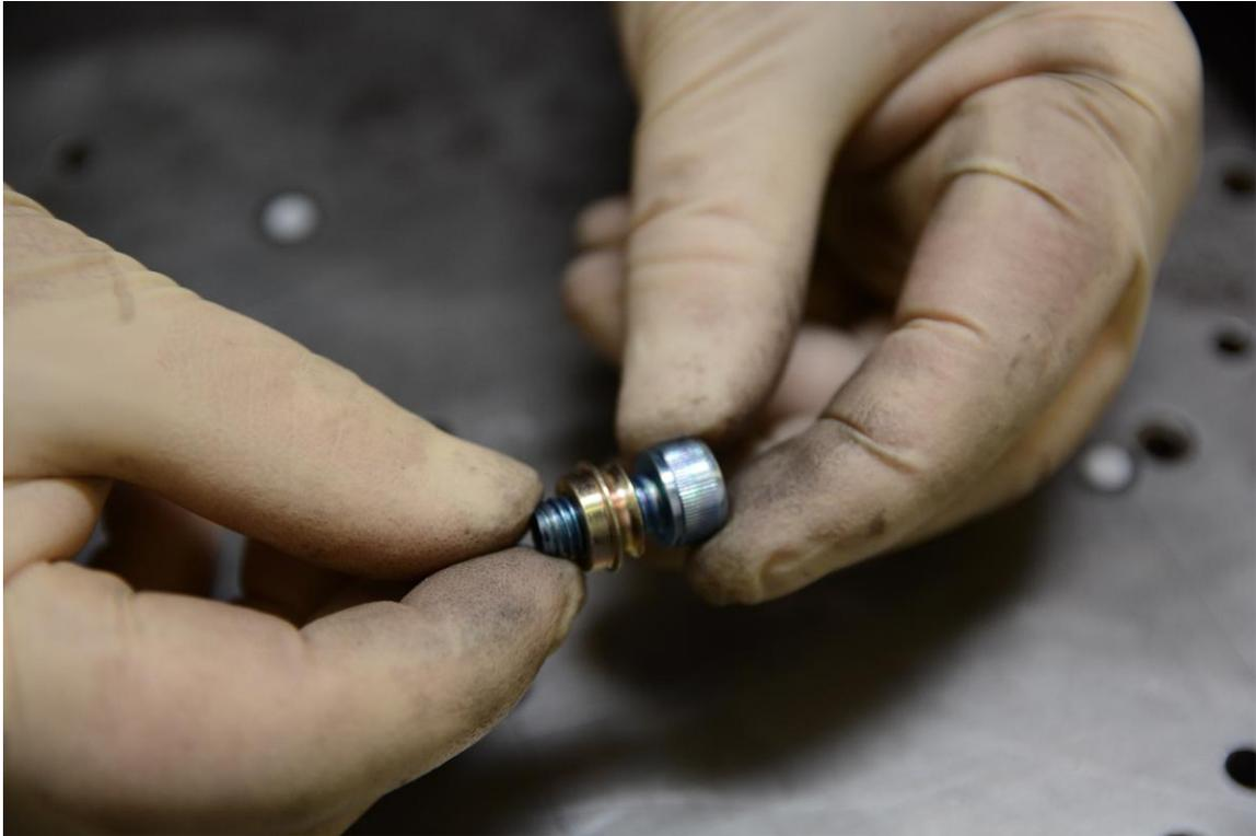
**Step 10** – Apply blue Loctite to Allen bolt.
