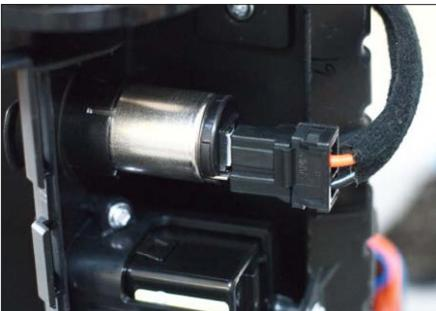
Der Stromanschluss erfolgt über das Anschlusskabel der 12V- Bordsteckdose
