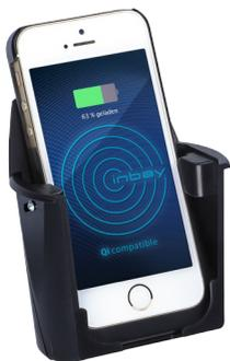
Der Inbay Ladebecher ist eine drahtlose Ladestation im Becherformat. Die Ladung erfolgt induktiv nach dem Qi-Standard und ermöglicht allen Smartphones mit Qi-kompatiblen Receivern ein drahtloses Laden bei gleichzeitig stabiler Ablage im Fahrzeug-Getränkehalter. Für einen sicheren Halt sind alle Fahrzeug-Getränkehalter mit 76 - 83 mm Durchmesser geeignet
