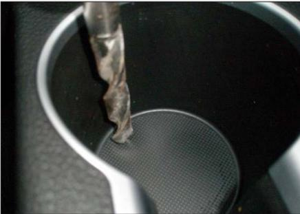
=> Bei Getränkehaltern mit festem Boden bohren Sie an geeigneter Stelle ein ca. 18 mm großes Loch zur Durchführung des USB-Anschlusskabels
